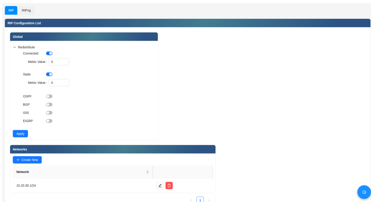
Hình 27: Giao diện hiển thị thông tin đường định tuyến động theo giao thức RIP
